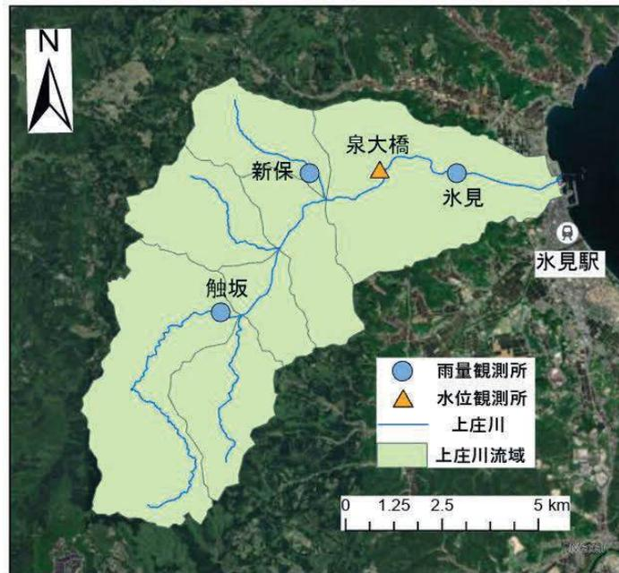
図-1 対象流域の概要および観測所の位置
