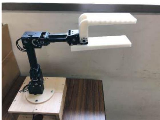
図3 ドンマス教授ロボットの腕の内骨格
